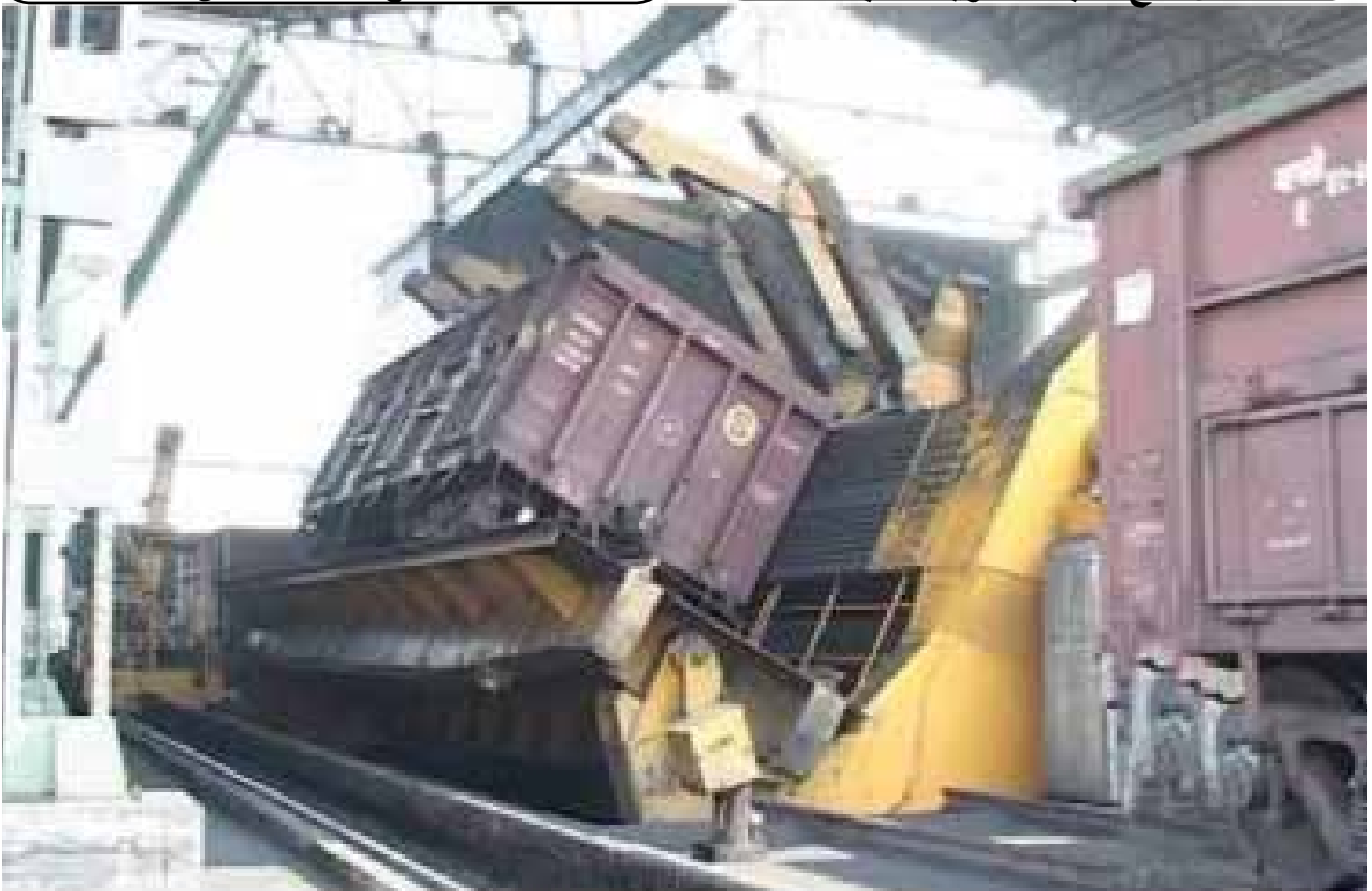
Wagon Tippler with 6 pause and 3 Clamping Cylinder عربات قلابة كبيرة مع 6 وقفات و 3 اسطوانات التحامل
